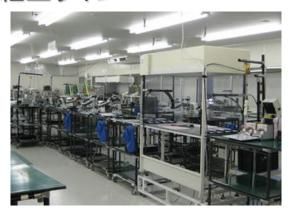
当社オリジナルで製作した作業台を使用することにより、大量生産・少量生産・複合した製品づくりに対応した組立ラインの切替えが自由に行えます。
